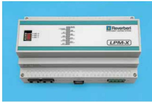
**Moduli intelligenti installati nel quadro per la gestione della comunicazione ad onde convogliate e l'interrogazione verso i moduli di controllo polo (LPS, LPC, D/LPC)./
